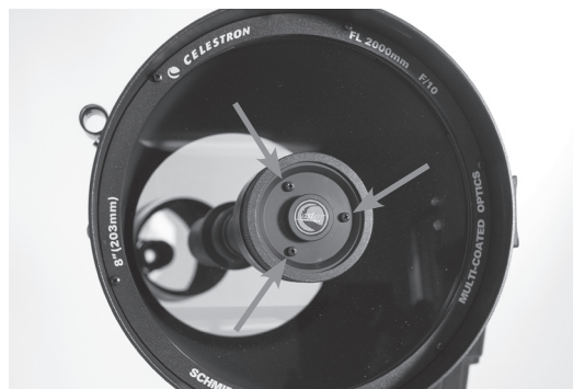
Vis d'ajustement de collimation du miroir secondaire
